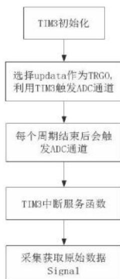
图 6 获取心率模块采集的原始数据流程图
